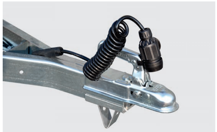
Spiralkabel mit 13-poligen Stecker für flexible Verbindung zum Zugfahrzeug (EG-Ausstattung).
